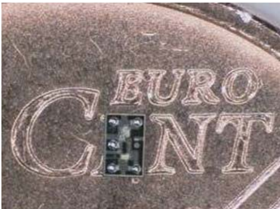
Größenvergleich zwischen WCSP-Gehäuse und 1-Euro-Cent Münze
