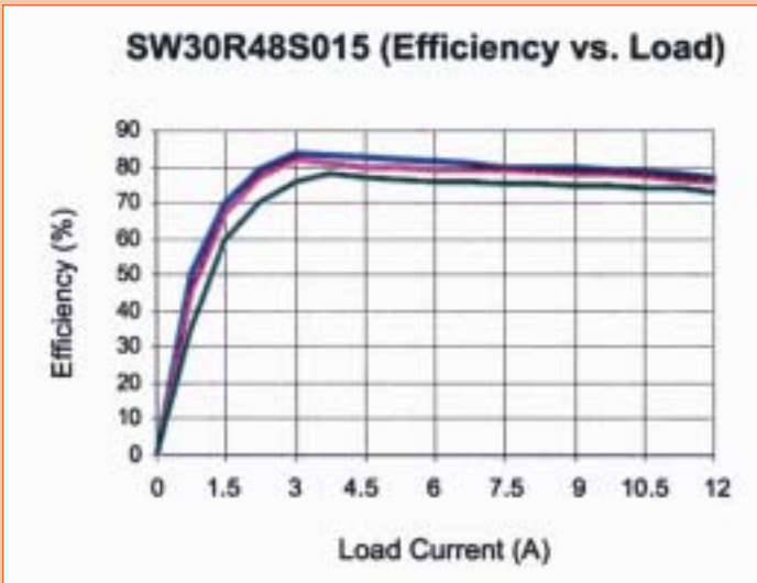
Wirkungsgrade von 83 Prozent bei 1,8 V Ausgangsspannung (Bild links) bzw. 92 bei Ausgang 5,0 VDC (Bild rechts) konnten mit Hilfe von Thermalmodellen für kritische Systemkomponenten erreicht werden
