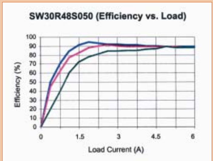
Wirkungsgrade von 83 Prozent bei 1,8 V Ausgangsspannung (Bild links) bzw. 92 bei Ausgang 5,0 VDC (Bild rechts) konnten mit Hilfe von Thermalmodellen für kritische Systemkomponenten erreicht werden
