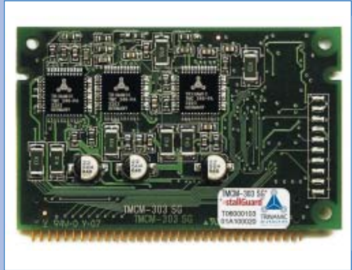
Das Plug-in TCM-303/SG-Modul mit sensorloser Lasterkennung und 3 TMC246-Treiber-ICs
