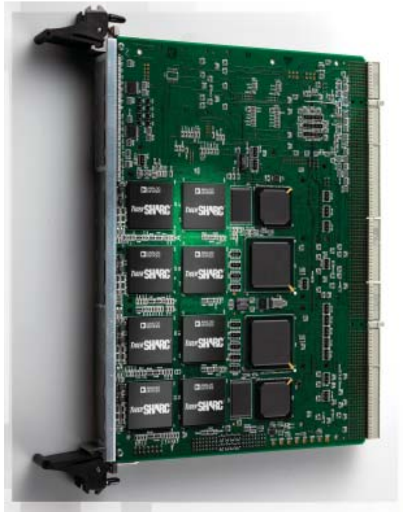
Basisband Board mit TigerSHARC Multi-Prozessor-Cluster
